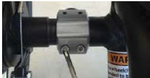
Fig. 10 Justering av avståndet mellan hjulen
