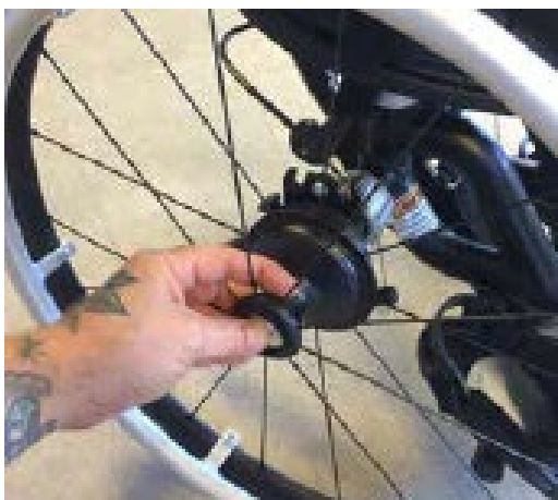
Fig. 11 Demontering/montering av hjul och nedläggning av ryggstöd
