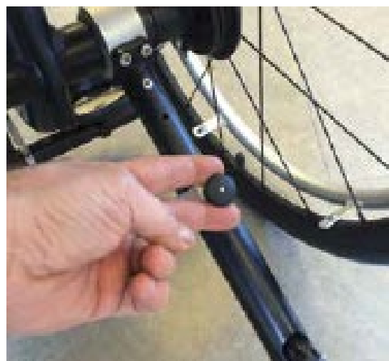
Fig. 09d Dra uppåt och tippskyddet utåt
