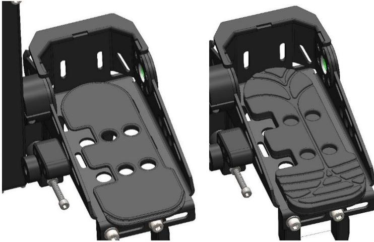
Bild 45+46 - Sohlen zum Ausgleich von Beinlängenunterschieden
