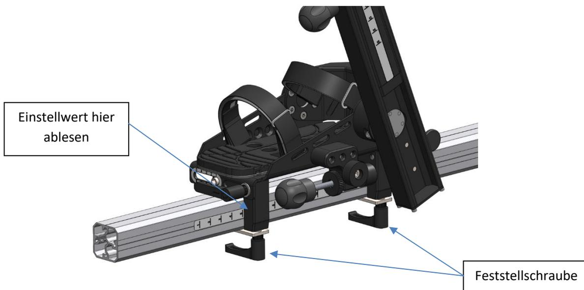
Bild 27. Position der Fußplatte
