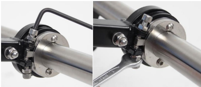
Fig. 29 Skruva in skruvar med 4 mm insexnyckel och dra åt kontramuttern med 8 mm skiftnyckel
