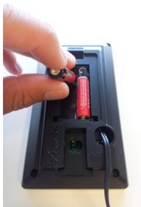
Bild 28. Byte av batteri, steg 1
